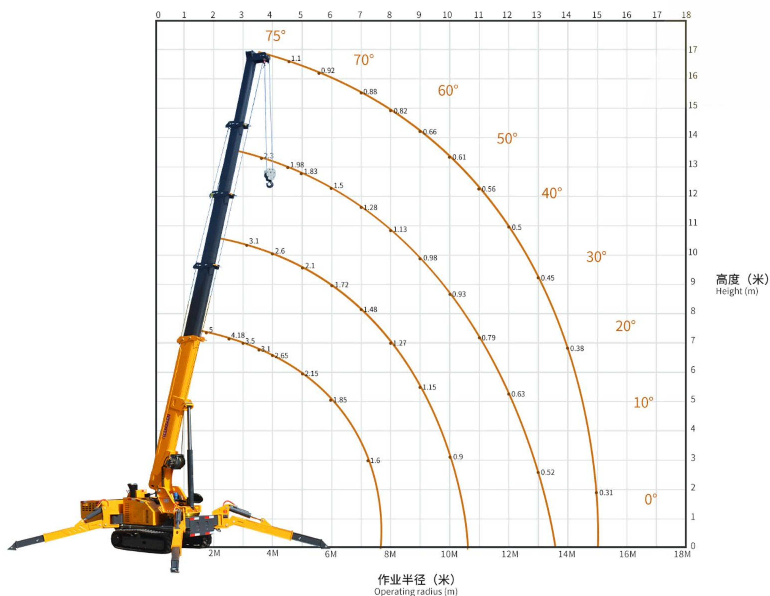
5吨蜘蛛吊机吊重表 5 ton spider crane lifting weight chart
